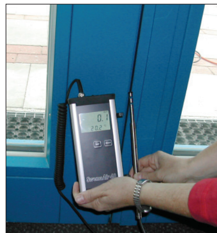
Измеритель скорости потока воздуха (источник: БлауэрДоор ГмбХ)
