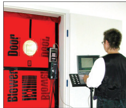
Определение перепада давлений (источник: БлауэрДоор ГмбХ)
